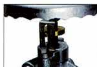
指示針が弁体の上下駆動に一致して上下に移動します。
